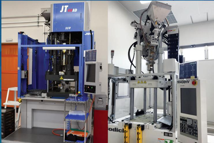
インサート部品を溶融樹脂で固定一体化することにより、樹脂強度の補強、可動部の樹脂磨耗の軽減あるいは、組立作業工程の短縮化等が期待できます。
